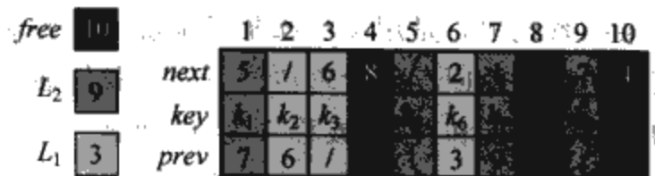
图 10-8 两个链表 L_1 (浅阴影)、 L_2 (重阴影) 和一个自由表(黑的)交叠在一起
