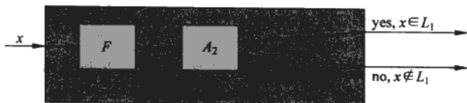
图 34-5 引理 34.3 的证明。算法 F 是一个归约算法，它在多项式时间内计算出从 L_1 到 L_2 的归约函数 f ， A_2 是一个能判定 L_2 的多项式时间算法。图中示出的是一个算法 A_1 通过利用 F 将任何输入 x 转换成 f(x) ，再利用 A_2 来判定是否有 f(x) \in L_2 ，最终判定是否有 x \in L_1 的过程
