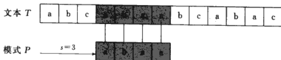
图 32-1 字符串匹配问题。目标是找出所有在文本 T = abcabaabcbac 中模式 P = abaa 的所有出现。该模式在文本中仅出现了一次，在位移 s=3 处。位移 s=3 是有效位移。模式中的每个字符都用一条竖线与文本中的匹配字符联系，且所有匹配的字符都涂了阴影
