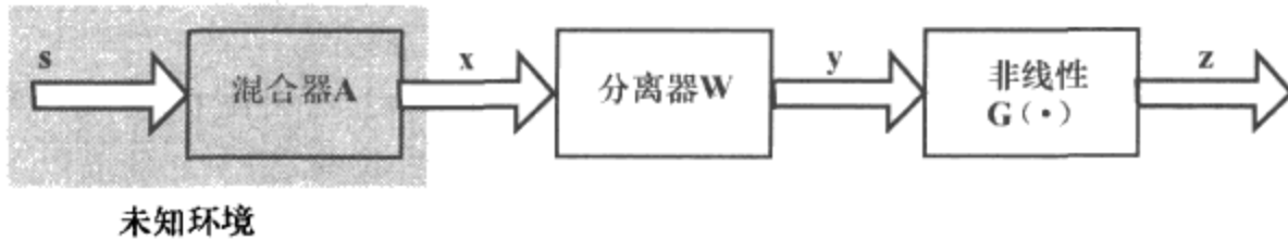
图 10.16 用于盲源分离的最大熵原则方框图。向量 s , x , y 和 z 分别是随机向量 S , X , Y 和 Z 的样本值
