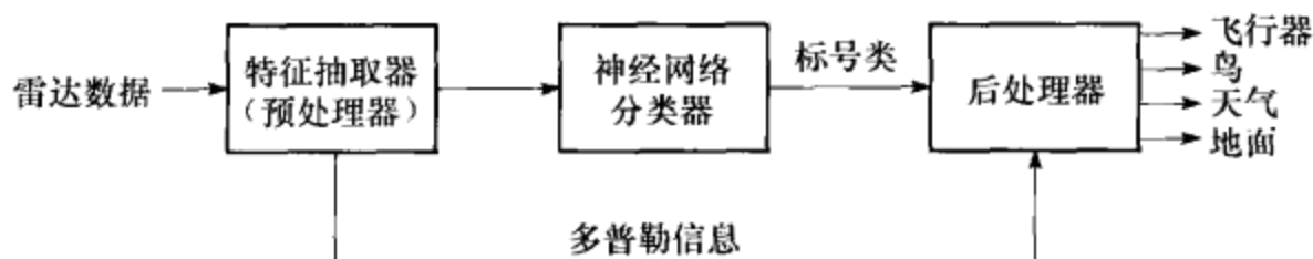
图 23 雷达信号的多普勒位移不变分类器
