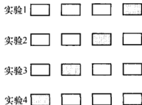
图 4.18 多重交叉验证的示意图。对一给定的实验，带阴影的数据集用来验证模型，而剩下的数据用来训练模型
