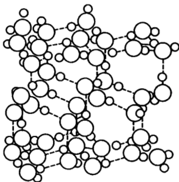
图 6.30 冰的氢键结构(大球表示氧原子,小球表示氢原子,虚线表示氢键)
