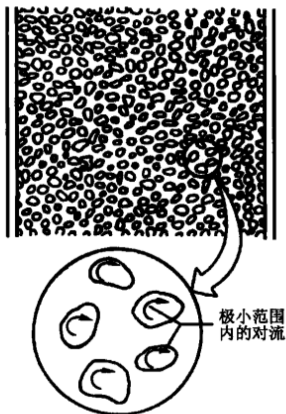
图 3.5 泡沫聚苯乙烯中有很多孔隙,大大减少了气体热对流,提高了绝热性能
