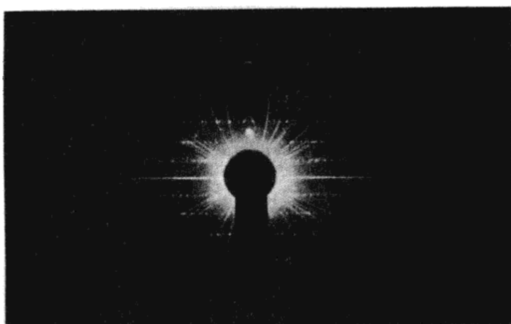
图 4.54 白钛硅钠石的 X 射线转动像, MoK α 线
