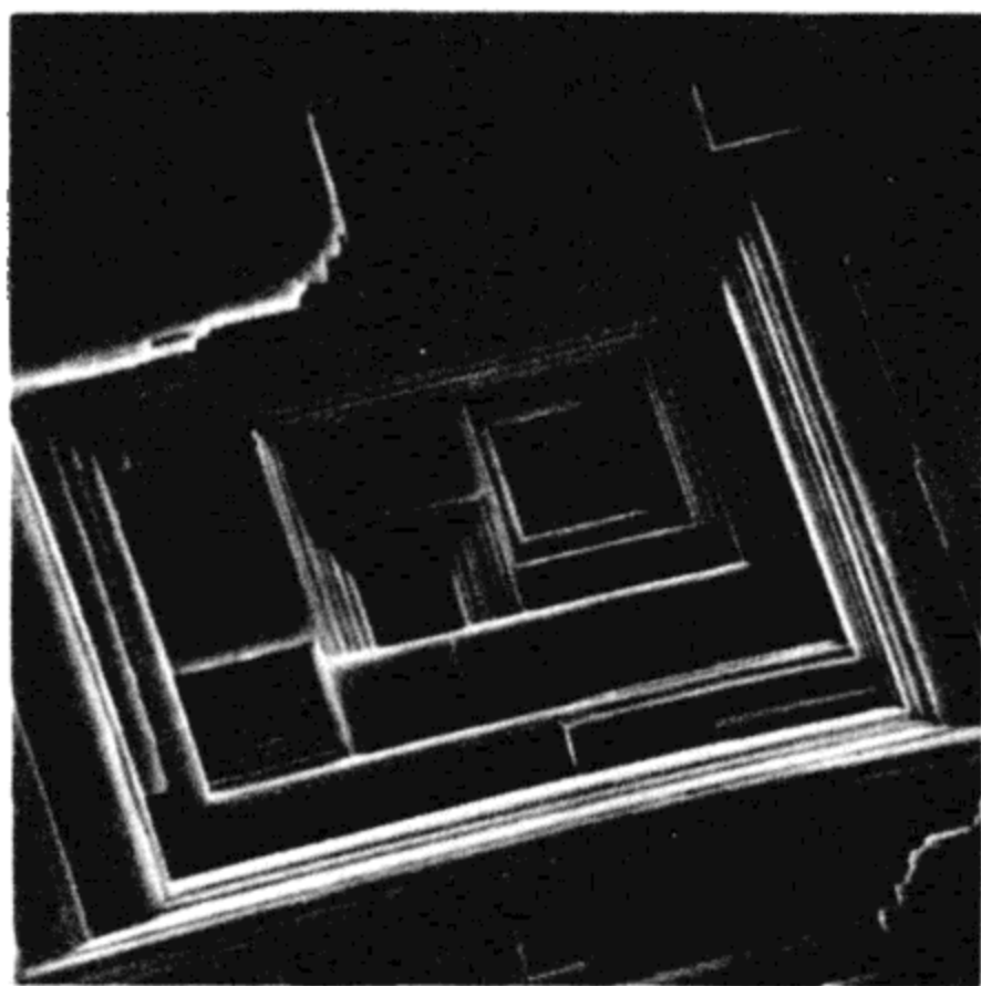
图 1.11 EuTe 表面出现的蒸发图形( \times 1520 ) [1,4]
