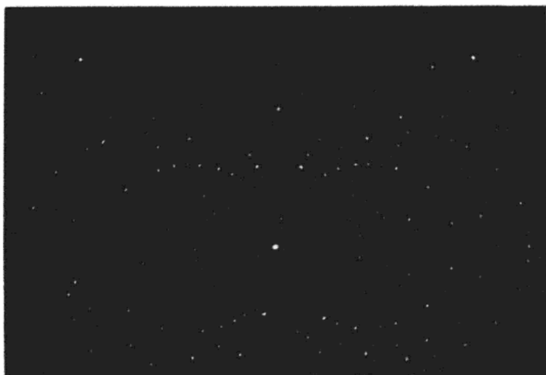
图 4.50 用未滤光 Mo 辐射得到的 [\text{C}(\text{NH}_2)_3]_4[\text{UO}_2\text{O}_2(\text{CO}_3)_2] \cdot 2\text{H}_2\text{O} 晶体的劳厄像 入射束和两个对称面的交线重合
