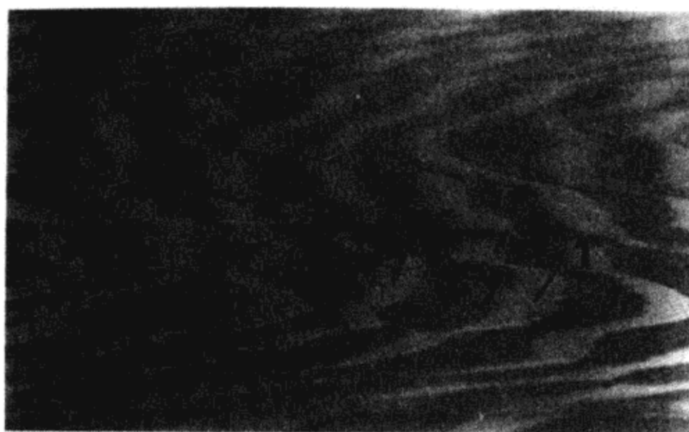
图 4.109 Si(111)表面反射电子显微像 约 830 °C 时从 1 \times 1 高温相(亮区)向 7 \times 7 (暗区)低温相转变,暗区左侧的弯折线是晶胞高度(0.31 nm)的原子台阶 [4.121]
